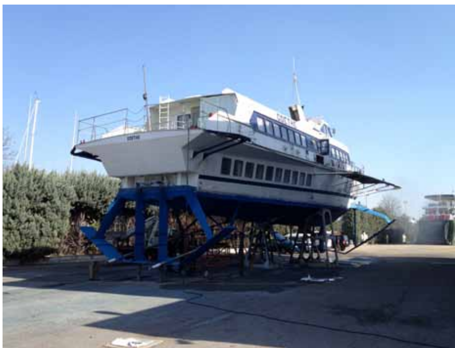
Fig. 1 - Aliscafo “Goethe” in fase di carenaggio sul piazzale
