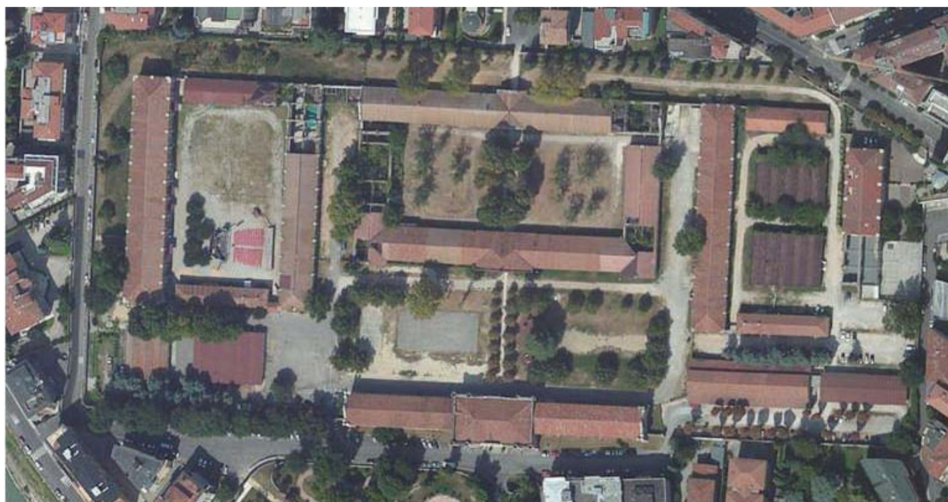
Fig. 5 - Foto aerea (Google map) dell'Arsenale nello stato attuale. Si notano le coperture in fibrocemento e le zone di degrado.
