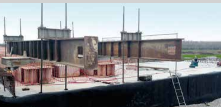
Autovie Venete – Collaudo pali di fondazione viadotti su Autostrada A4
